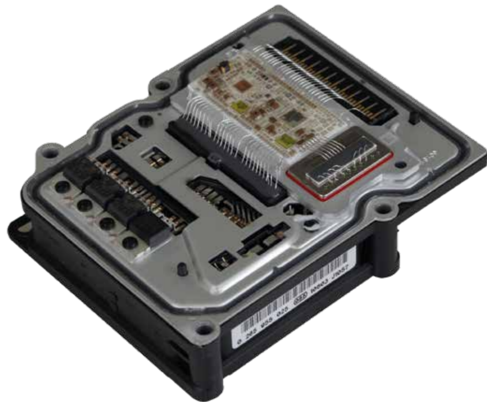
Een kijkje in de ECU van een Bosch 8 ABS-systeem met ESP.
