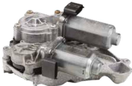
Il selettore del cambio è composto da due motorini elettrici che realizzano la sezione e l'innesto delle marce. Come già spiegato, entrambi i motorini sono comandati dalla TCU presente nel Durashift.
