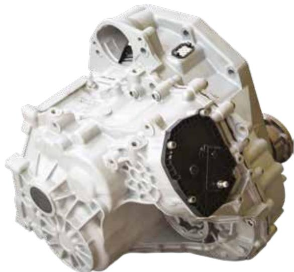
Il cambio DSG7 è un cambio automatico a doppia frizione. DSG sta per 'Direktschaltgetriebe' o 'Direct-Shift Gearbox', ovvero cambio a innesto diretto, e il 7 indica che ci sono sette marce avanti. Per questo cambio viene utilizzata anche la denominazione 'DQ250'. La Q (di 'Quermotor') indica che questo cambio viene montato con i motori trasversali.
