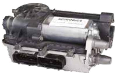
Durashift è dunque il nome della Meccatronica che controlla la frizione e il selettore del cambio. Il componente è composto da una TCU, un attuatore della frizione e un motorino elettrico.
