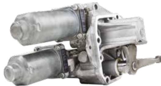
Il selettore del cambio è composto da due motorini elettrici che realizzano la sezione e l'innesto delle marce. Come già spiegato, entrambi i motorini sono comandati dalla TCU presente nell'Easytronic.
