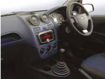
La trasmissione Durashift è un cosiddetto cambio meccanico robotizzato basato sul cambio meccanico Ford a cinque marce iB5. Il Durashift consente tanto il cambio automatico delle marce, quanto l'innesto manuale mediante la leva del cambio. In entrambi i casi, la frizione viene azionata automaticamente.
