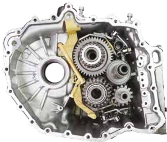
Il cambio DSG6 è un cambio automatico Volkswagen. DSG sta per 'Direktschaltgetriebe' o 'Direct-Shift Gearbox', ovvero cambio a innesto diretto, il 6 indica che ci sono sei marce avanti. Per questo cambio viene utilizzata anche la denominazione 'DQ250'. La Q (di 'Quermotor') indica che questo cambio viene montato con i motori trasversali.
