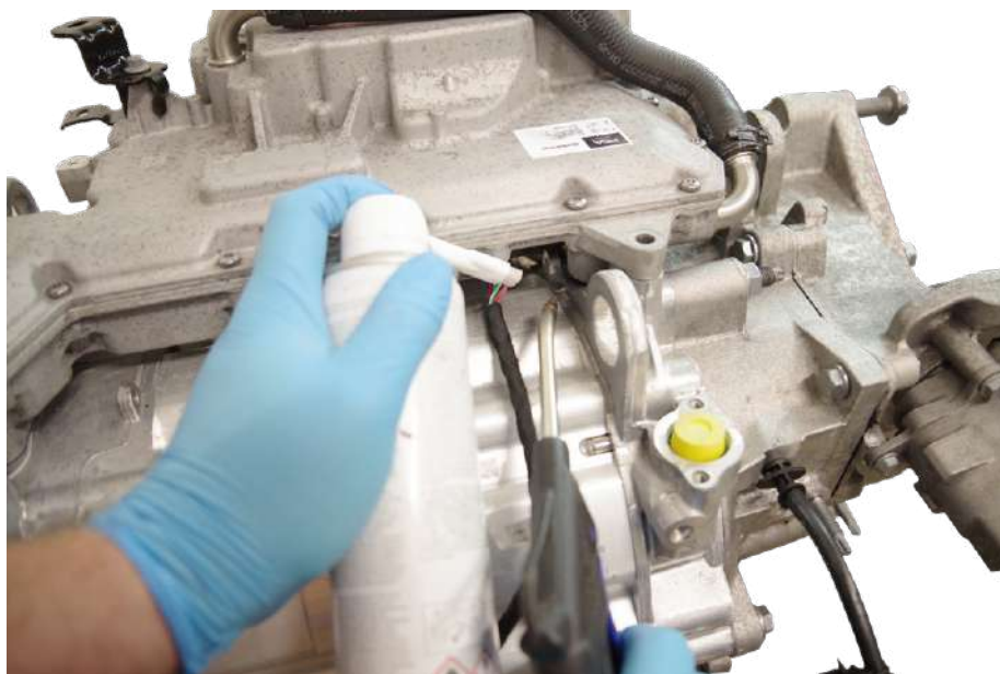
Reinig de omgeving van de koelvloeistofverbinding tussen de Power Electronics Unit (PEU) en de elektromotor zorgvuldig. Verwijder hierbij alle vuil- en stofdeeltjes om verontreiniging van het systeem te voorkomen.
