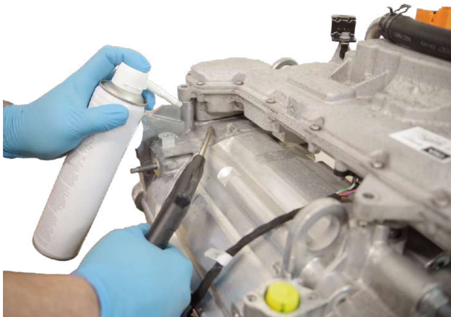
Reinig de omgeving van de elektrische verbinding tussen de Power Electronics Unit (PEU) en de elektromotor.
